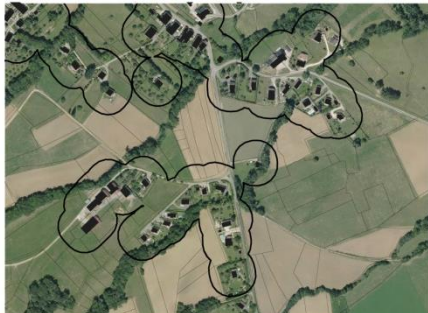
Fusion des tracés obtenus La fusion des polygones précédemment tracés autour du bâti permet de mettre en évidence des petits groupes de bâtiments proches appartenant à une même logique urbaine. Elle exclue ainsi les nombreux petits interstices pouvant exister entre des bâtiments peu éloignés.
