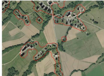
« Erosion » de 25 mètres Le tracé est resserré de 25 mètres afin de ramener l'enveloppe urbaine retenue à une distance plus raisonnable du bâti. Celle-ci est donc de l'ordre d'une quinzaine de mètres par rapport aux limites extérieures des bâtiments.
