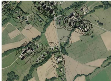
Tampon 40 mètres autour du bâti Un tampon automatique est appliqué sur tout bâti supérieur à 20m 2 . La distance retenue est suffisamment importante pour permettre de croiser les « tampons » de plusieurs bâtiments peu éloignés.
